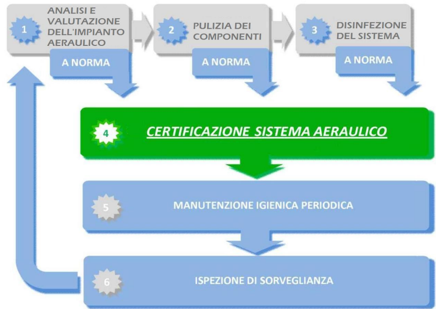
Schema dei servizi di sanificazione per la messa in servizio degli impianti di ventilazione e la loro manutenzione
